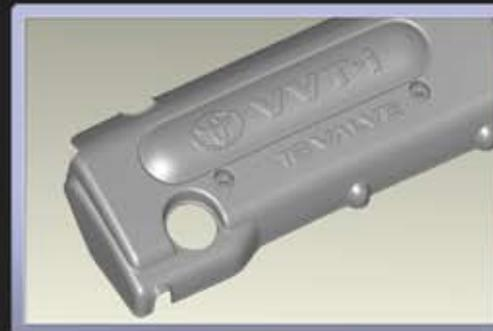
Rexcan4 использует технологию оптической триангуляции с фазовым смещением и двухобъективную фотокамеру с ПЗС-матрицей с высокой разрешающей способностью, что обеспечивает высокую точность данных при минимальных погрешностях и поверхностном шуме менее 10 мкм.
